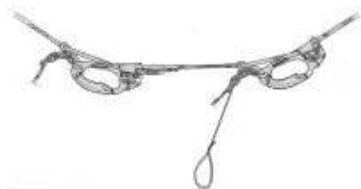
Si les amarrages intermédiaires de la main-courante sont assez rapprochés et qu'elle est suffisamment tendue, il est assez aisé de faire passer le blessé d'un tronçon de corde au suivant, en réalisant, par exemple, un petit balancier successivement sur chaque amarrage intermédiaire, on soulage la tension sur ses longes et on peut ainsi les transférer.
