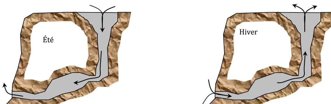
Figure 34 Tube à vent- P-M Abadie
