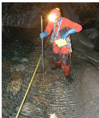
Figure 37. Mesures des vitesses le long d'une section de rivière souterraine, pour en calculer le débit. Stage équipier scientifique. Photo S. Jaillet.
