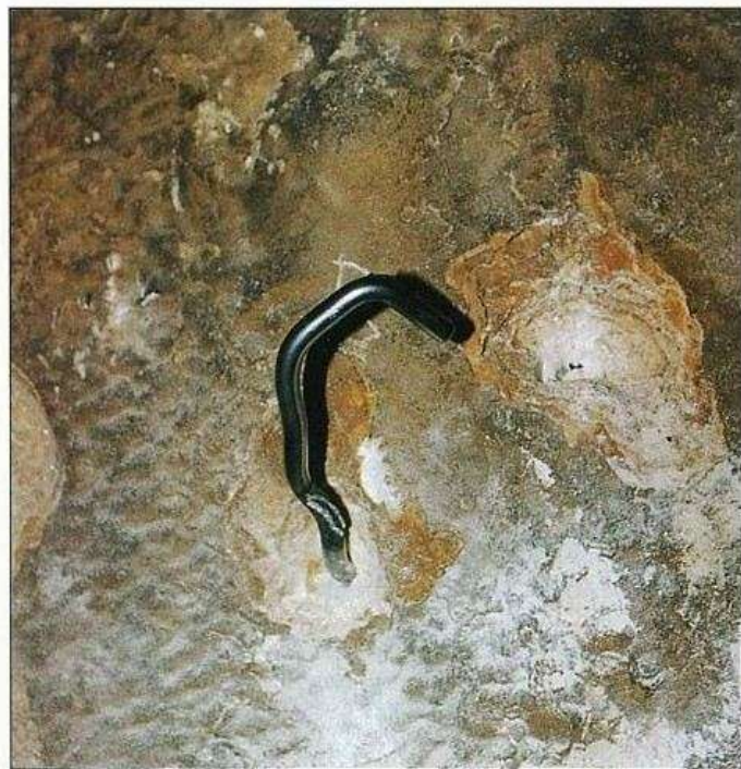
Starfix sollicité au cisaillement en calcite dure jusqu'à 1750 daN. Rupture de la soudure fermant l'anneau.
