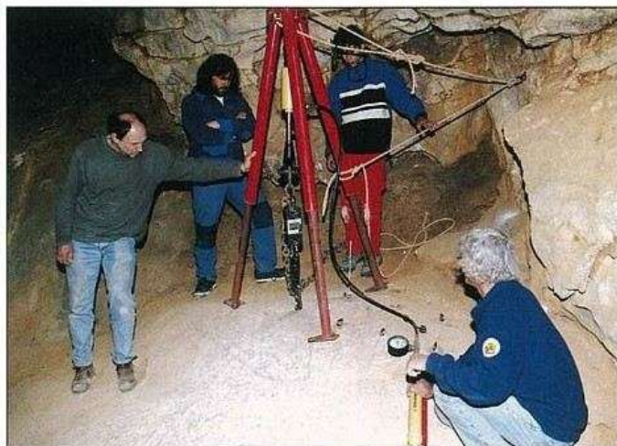
Tests à l'arrachement sur un plancher de calcite. Tous les trous ont été gorgés d'eau puis vidés avant collage.
