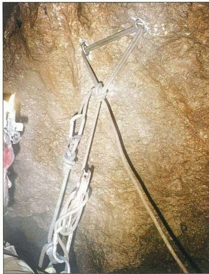
Autre solution : 1 seul nœud de chaise en double passant les 2 ancrages. Consommation de corde moins importante. Amarrage plus clair. Dans les 2 cas, on peut se longer dans la ganse du nœud de chaise (meilleure solution, clé de longéage p.32).
