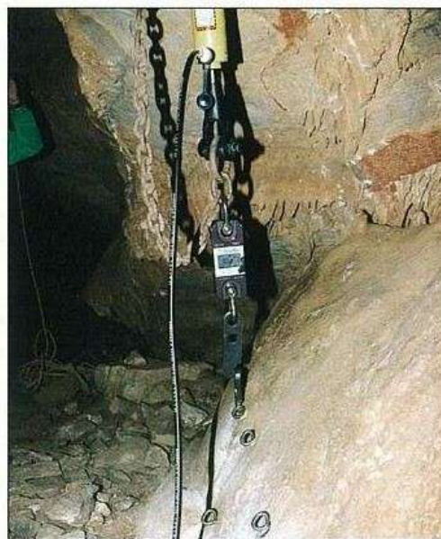
Test de résistance au cisaillement d'une broche scellée en calcite
