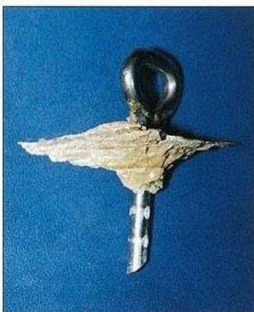
Broche après arrachement à 1774 daN en vieille calcite poreuse. Dans les roches tendres, on constate en général l'arrachement du rocher, (ici partie de cône, resté sur la broche) alors qu'en roche dure, c'est la liaison résine broche qui lâche.
