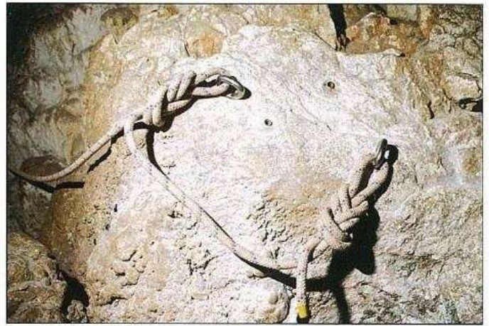
Équipement sans connecteurs en départ de main courante : 2 nœuds de huit.
