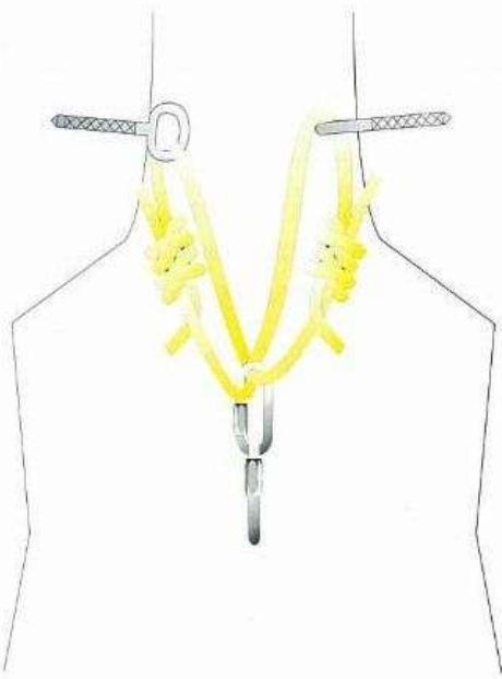
Relais pour un départ de rappel en sommet de puits étroit.
